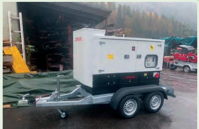
Neues mobiles 80-KVA-Notstromaggregat
